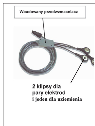
Ryc. 16: Kable elektrod z wbudowanymi przedwzmacniaczami System NORAXON INC USA
