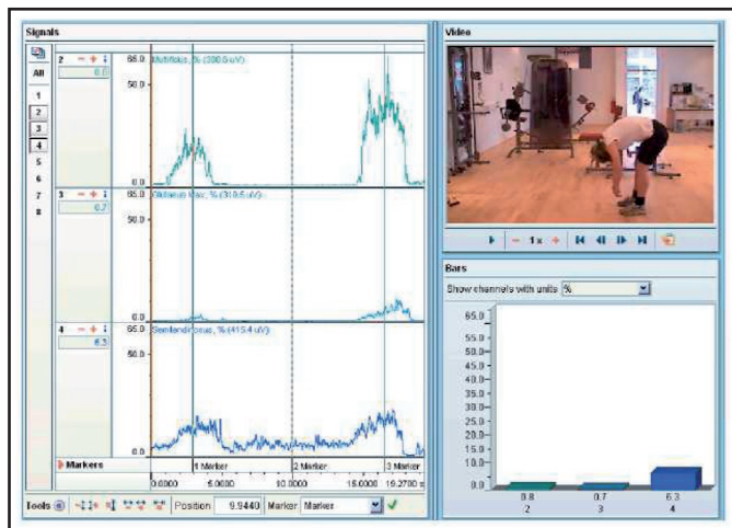
Ryc. 67: Zjawisko zginania-rozluźniania. Przy powolnym wykonywaniu skłonu w przód z pozycji wyprostowanej, mięśnie grzbietu (kanał 1 – m. wielodzielne) oraz prostowniki biodra (kanał 2, m. pośladkowy większy) są wyłączone w największym zgięciu (przerwana linia na wykresie i zdjęcie). Masa kończyna jest utrzymywana przez struktury bierne jak wieszadła. Przy powolnym prostowaniu się oba mięśnie znów rozpoczynają swoją funkcję. Inni synergici (kanał 3 – ścięgna podkolanowe) są aktywni przez cały czas. U pacjentów z bólami krzyża nie występuje powyżej opisana cisza unerwienia z powodu zaburzenia funkcji lub dolegliwości bólowych.
