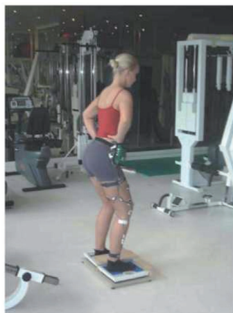
Ryc. 25: Mocowanie kabla za pomocą pasów elastycznych i taśmy
