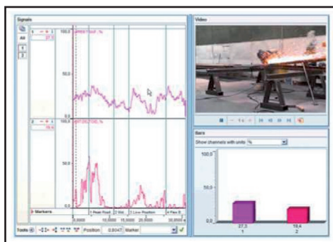
Ryc. 76: Ergonomiczna analiza EMG dwóch mięśni naramiennych (wykres górny – m. czworoboczny cz. zstępująca; wykres dolny – m. naramienny przedni) podczas pracy w hucie żelaza. Sygnał znormalizowany MVC przedstawiają wysiłek mięśniowy w czasie wykonywania ruchu pokazanego na zdjęciu.
