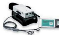
Ryc. 16: Kable elektrod z wbudowanymi przedwzmacniaczami System NORAXON INC USA
